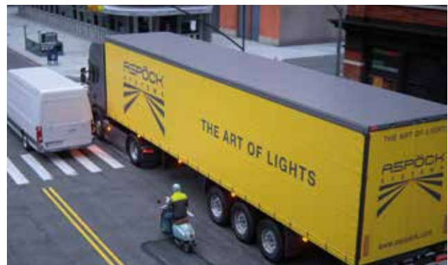
Blinkende Seitenmarkierungsleuchten entlang des LKW-Anhängers bieten einen enormen Sicherheitsfaktor für andere Verkehrsteilnehmer:innen.
